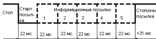
Рис. 8.1. Структура телетайпного сигнала
