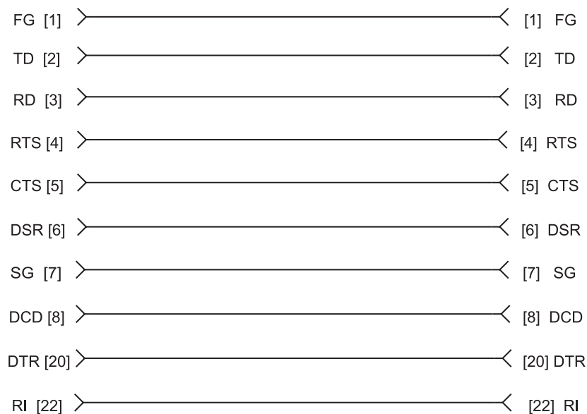
Рис. ПЗ.1. Соединение компьютера и модема
